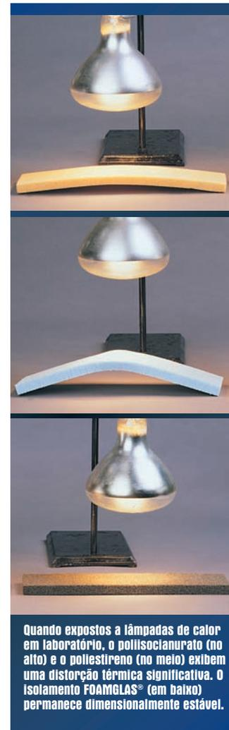
Quando expostos a lâmpadas de calor em laboratório, o poliisocianurato (no alto) e o poliestireno (no meio) exibem uma distorção térmica significativa. O isolamento FOAMGLAS® (em baixo) permanece dimensionalmente estável.
