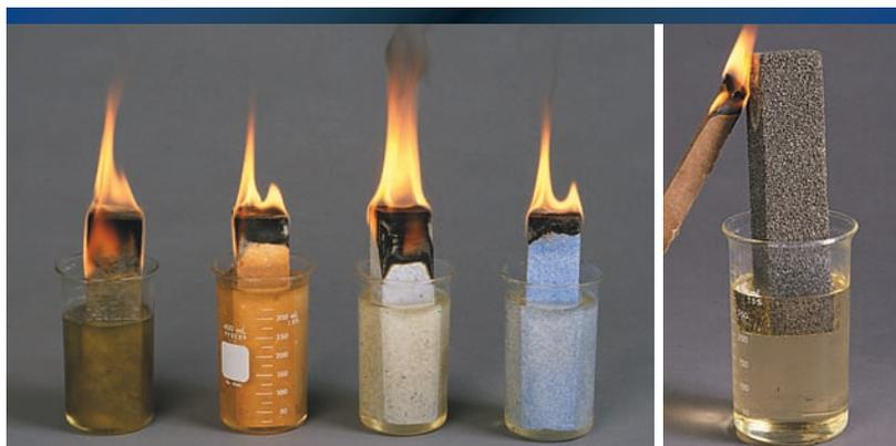
O isolamento FOAMGLAS® (acima) continua a ser não absorvente e não combustível, enquanto que na lã mineral, silicato de cálcio e duas marcas diferentes de perlita há a formação de chamas por terem absorvido o óleo.
