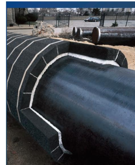
O isolamento FOAMGLAS® foi instalado como parte de um sistema composto de isolamento. Incorpora uma camada de uma polegada de feltro de fibra de vidro aplicado diretamente em torno do tubo e coberto com o isolamento FOAMGLAS®.
